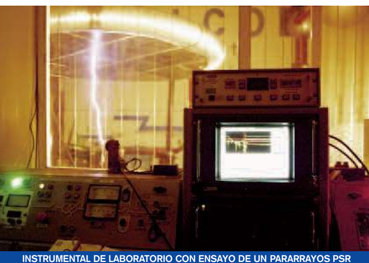
INSTRUMENTAL DE LABORATORIO CON ENSAYO DE UN PARARRAYOS PSR
