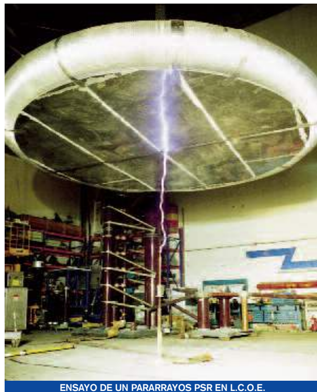
ENSAYO DE UN PARARRAYOS PSR EN L.C.O.E.
